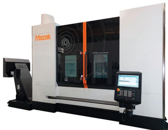
Sieben in Europa gebaute Modelle der vertikalen Fahrständer-BAZ der Mazak-Serie VTC werden inzwischen mit Sinumerik-Steuerung von Siemens angeboten (© Mazak)
